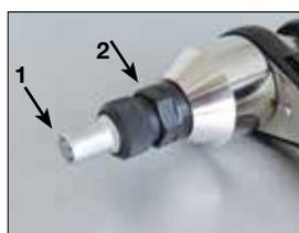
Avvitare l'inserto sul tirante, regolare la ghiera in modo da posizionarlo a filo con la testina.
