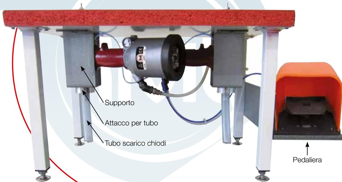
Per rivetti a strappo standard e strutturali e bulloni a strappo.
