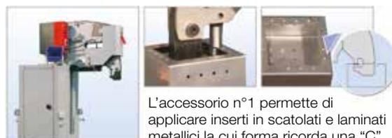
L'accessorio n°1 permette di applicare inserti in scatolati e laminati metallici la cui forma ricorda una "C".
