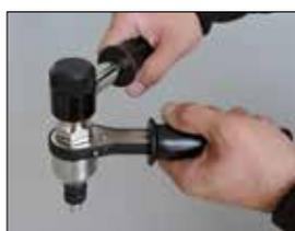
Usare la leva superiore come supporto e ruotare la leva inferiore in senso orario.
