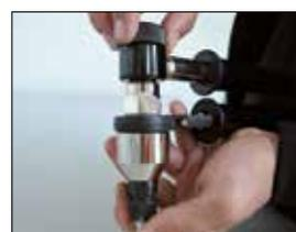
Ruotare la leva inferiore in senso antiorario per sbloccare e poi svitare il tirante ruotando il pomello.
