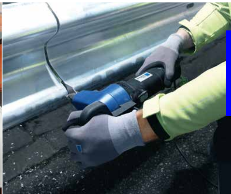
N500 - Ideale per taglio guardrail
