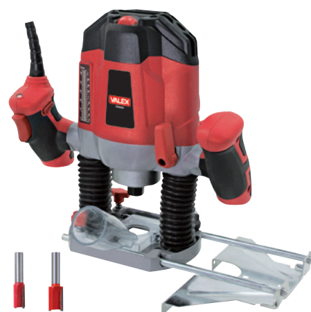
1467017 FRESATRICE VERTICALE F1300C 1300W. Giri/min 11000-30000. Con guide per fresature parallele, circolari, fori, copia profili, 2 mandrini per frese ø6mm e ø8mm.
