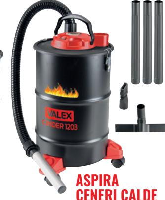
1350135 ASPIRACENERE PER CENERI CALDE CINDER 1203 Potenza 1200W. Fusto 20lt. Tubo flessibile in metallo. Filtro a cartuccia HEPA lavabile e autoestinguente con doppio filtro metallico interno/esterno e prefiltro ignifugo. Con funzione di soffiaggio e kit aspirapolveri.
