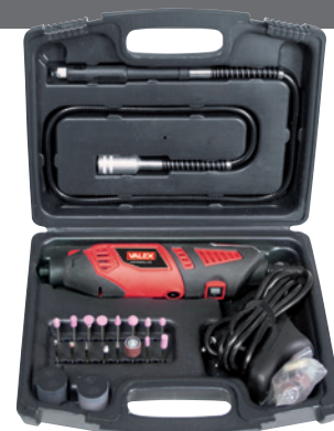
1401602 MULTIUTENSILE UNIVERSAL 410 170W. Giri/min 8000-35000. Con pinze diametro 1,6-2,4-3,2mm, abrasivi e albero di trasmissione flessibile.
